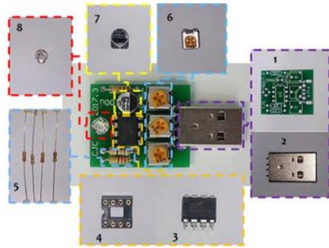
Fig. 4. mini DIY LED light-adjusting board
